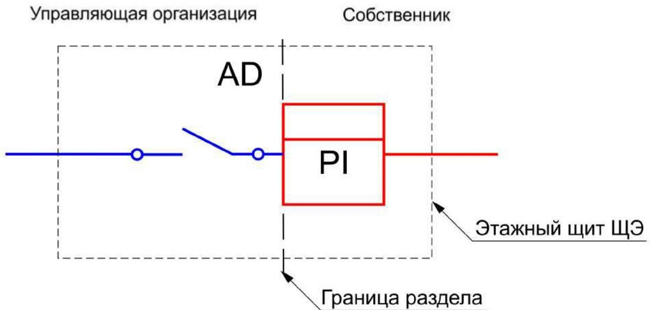
**AD** – вводной автоматический дифференциальный выключатель. **PI** – узел учета электрической энергии.
