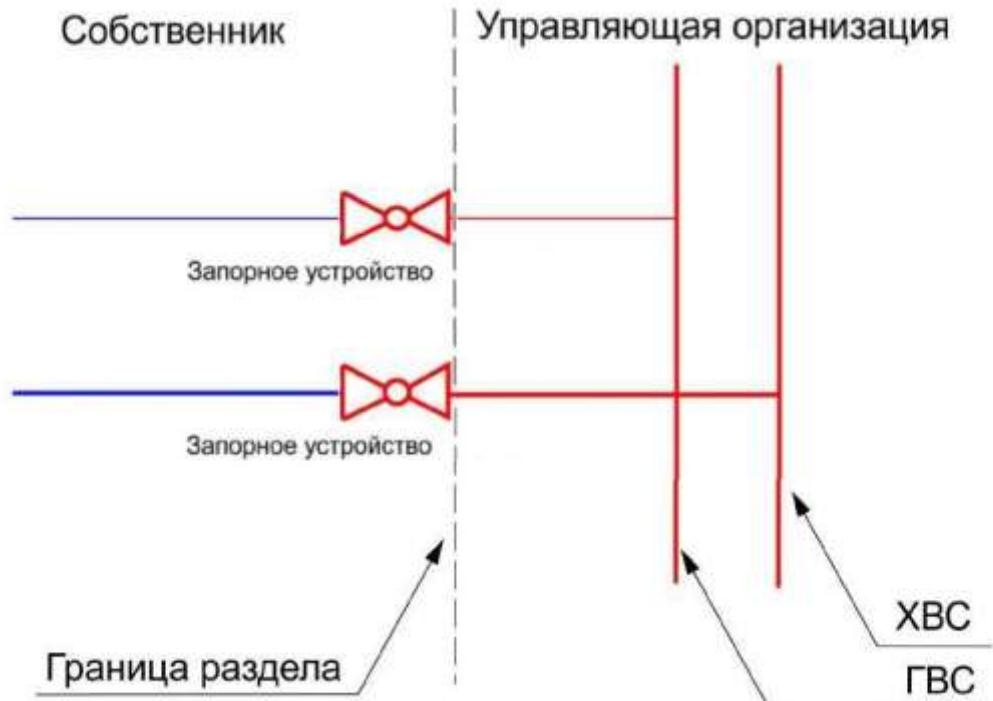
Граница ответственности за состояние и содержание систем холодного и горячего водоснабжения проходит до первого запорного устройства на стояке ГВС, ХВС.
